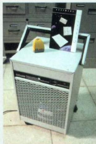
DESHUMIDIFICADOR Y DATA LOGGER DE TEMPERATURA Y HUMEDAD.
