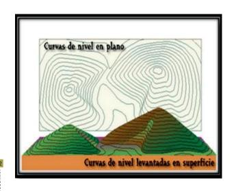
RECUERDE: Una curva de nivel es una línea de color castaño en su carta topográfica que conecta puntos que tienen la misma elevación.
