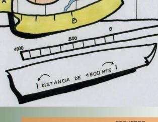
Cuando se tiene que recorrer cierta distancia a pie, sin que haya puntos en el terreno que puedan usarse como referencia, las distancias se pueden calcular y medir con bastante precisión mediante la cuenta de sus pasos (o calzada).
