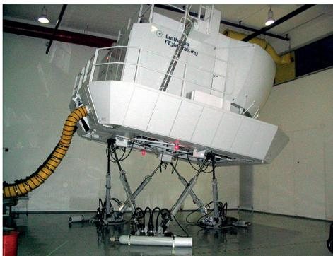
Figura 26. Plataforma steward en uso en simulador de Lufthansa.
