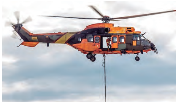
Helicópteros militares con pintura para evitar colisiones entre aeronaves. A la izquierda, helicóptero AS-532 de la UME 29 , España. A la derecha, helicóptero UH-60 de la Guardia Nacional del Ejército del Estado de California, Estados Unidos.
