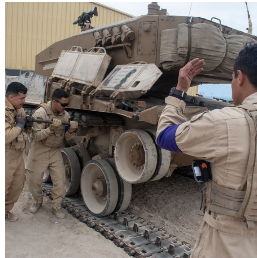
La tripulación debe reparar un corte de la oruga de un tanque. Para ello, todos los integrantes efectúan tareas específicas para que, en el menor tiempo posible, el tanque esté en condiciones de ejecutar misiones.
