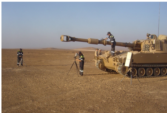
Figura N° 2: Determinación de la velocidad de un proyectil de obús 155 mm autopulsado (M109), mediante el uso de un radar, por parte de personal del IDIC-DSA.
