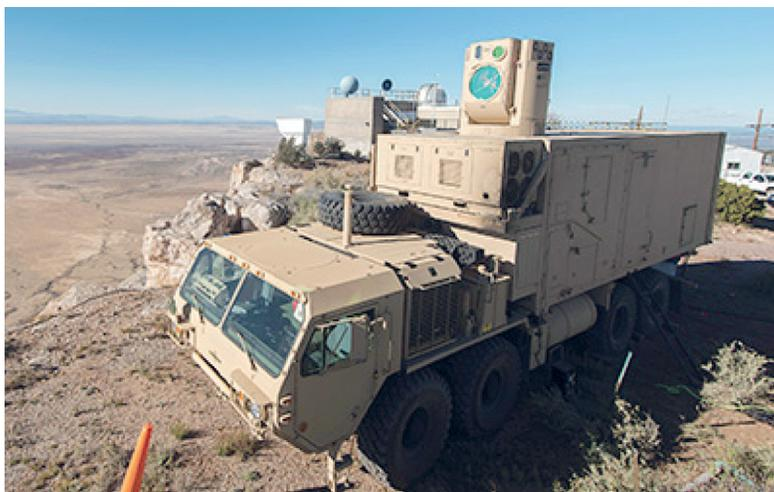
Figura N° 4: Vehículo equipado con un sistema láser de alta energía (HEL), para destrucción de amenazas aéreas y/o terrestres.
