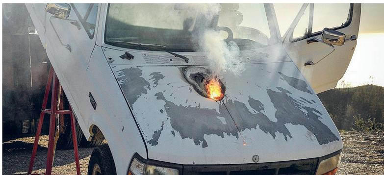
Figura N° 3: Impacto de un ataque láser (sistema Athena – Lockheed Martin) sobre el compartimiento del motor de un vehículo.
