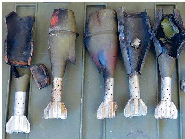
Figura N° 2: Proyectiles de mortero neutralizados utilizando un arma láser de alta energía (HEL).
